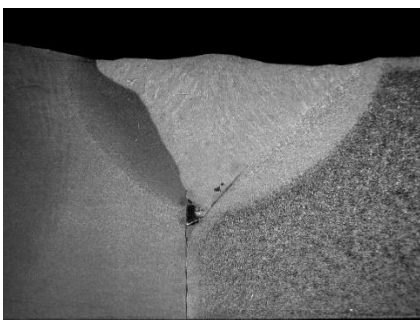
Figure 5 : Soudure MAG en 1 passe réalisée à une vitesse de soudage de 35 cm/min avec une vitesse de fil trop importante.
